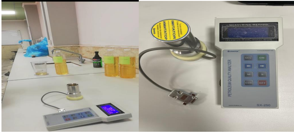
الشكل (2) جهاز تحليل جودة المنتجات النفطية
